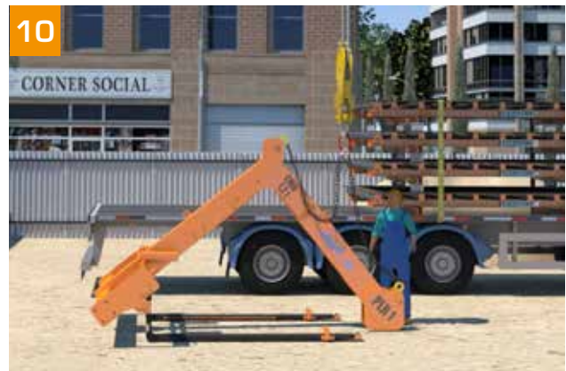
- Lasttraverse auf dem Boden abstellen (klappt wieder zusammen).
