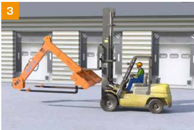
3 Erste Lademethode: Aufnahme in den Aussparungen ...
