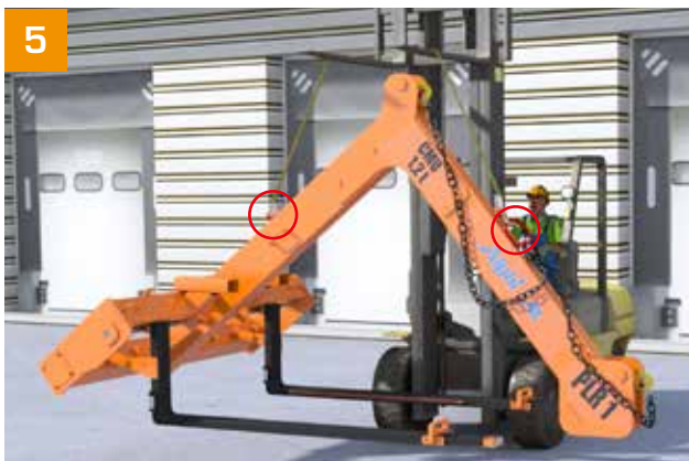
5 Zweite Lademethode: mit einem Hebegurt mit einer Zertifizierung für 2 Tonnen. - Hebegurt an den speziellen Hebepunkten anbringen.
