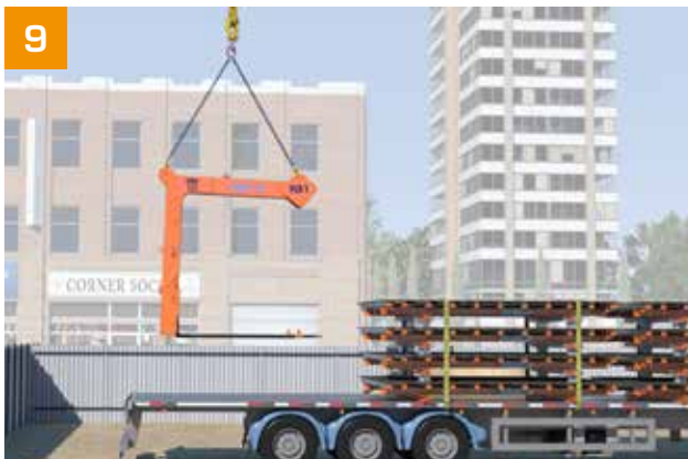
- Die Lasttraverse klappt sich beim Heben automatisch auf.
