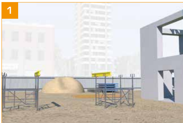
1 - Montagetisch aus 2 Gerüsttürmen mit Holzträgern aufbauen.
