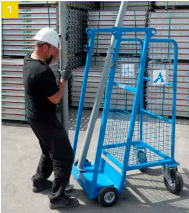
- Présentation des étais en position verticale.
