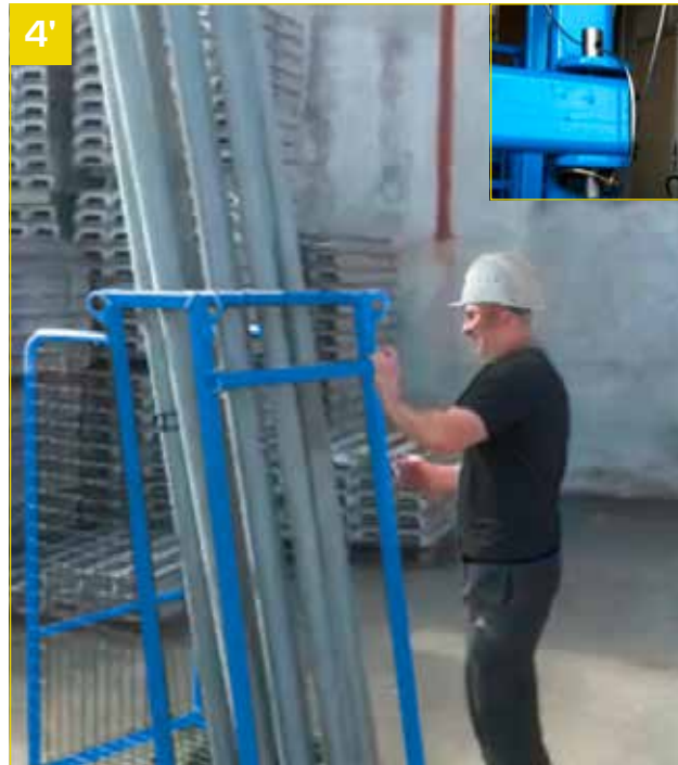
- Verrouillage par goupille imperdable.
