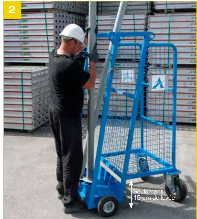
- Mise en place des étais dans le chariot.
