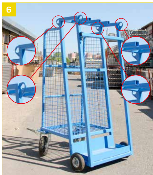
- Anschlagpunkte: Das Transportgestell verfügt über 4 Ösen dank denen es mitsamt Stützen per Kran transportiert werden kann.
