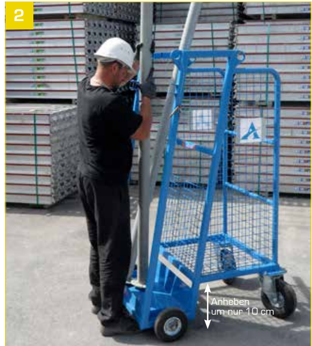
- Einsetzen der Stützen in das Transportgestell.
