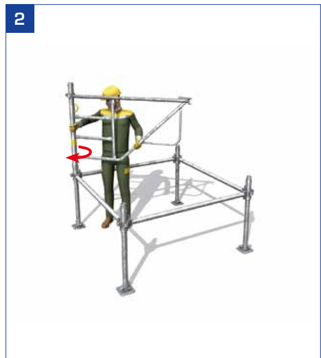
- Den ersten Rahmen vom Inneren des Turms aus in der Mitte der Diagonale einsetzen und dann zum Verriegeln drehen.
