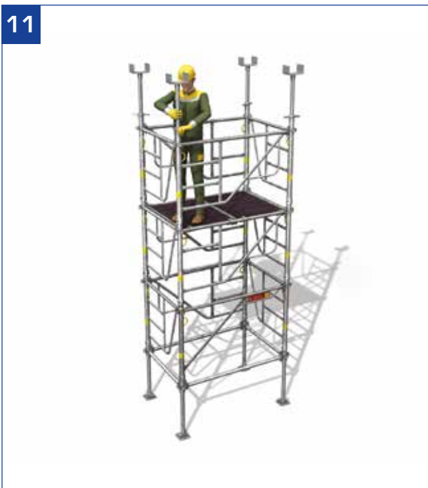
- Einsetzen und Einstellung der Kopfspindeln.
