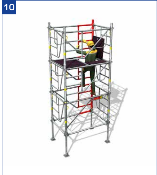
- Die erste Belageebene kann nun entfernt werden. Zugang zu der oberen Ebene über die integrierte Leiter.
