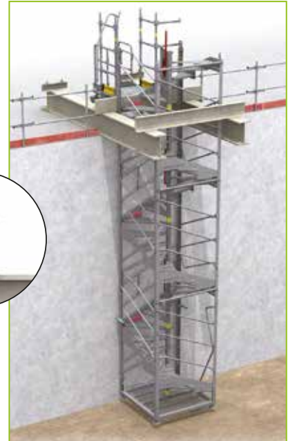
- Schéma d'un Escalib MDS suspendu pour accéder au fond de fouille.
